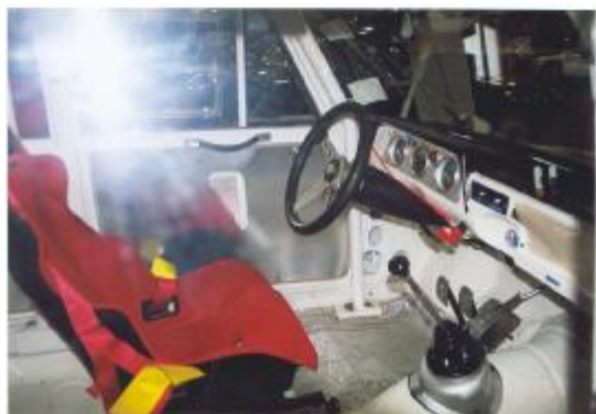
Oprema v GIULIA TI SUPER / 1964 Homologiran sedež , štiritočkovni pas , gasilna naprava , prekinjevalec električne napetosti, cevna zaščitna kletka itd.
