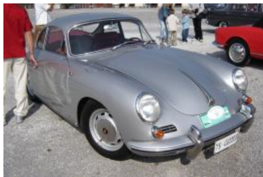
PORSCHE 356 A iz leta 1956 1600 ccm motor ima 60 KM / 4500 Izdelanih je bilo 21.045 vozil treh serij A,B in C
